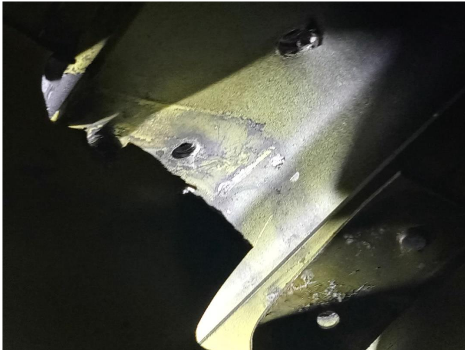
Figura 5. Fotografía de costilla afectada
