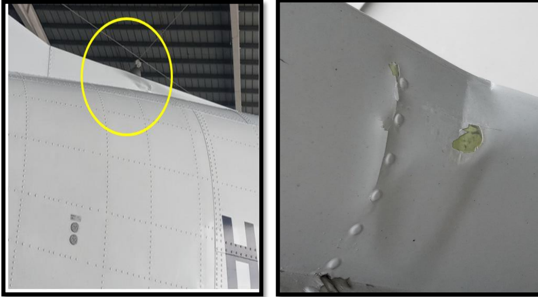
Figura 6. Golpe en alera dorsal de estabilizador
